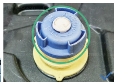
Rezervor cu dopul nedeteriorat
