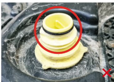
Lipsește capacul rezervorului
