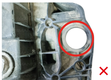
Silențios deteriorat sau lipsă
